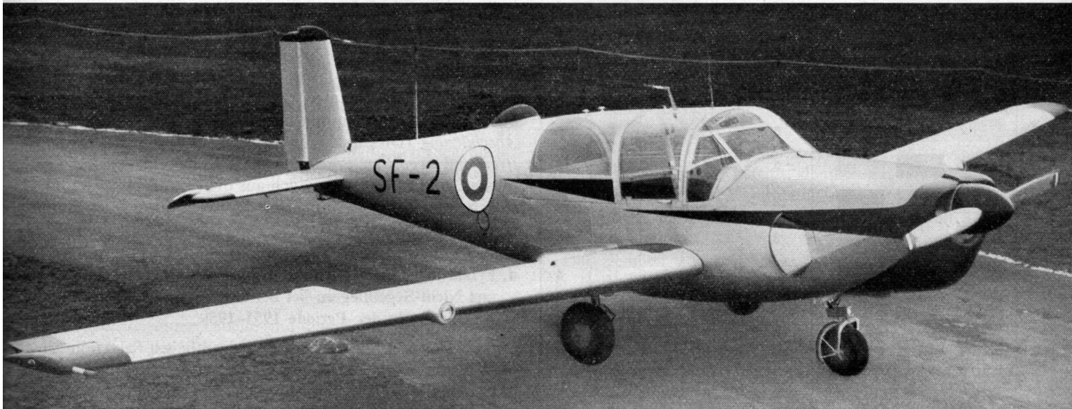
Abb. 5. Das künftige Selektions- und einmotorige Schulflugzeug der Reichsluftfahrtschule, SAAB-Safir 91 D mit 4-Zylinder-Lycoming 0-360-A1A, 180 PS und Luftschaube mit gleichbleibender Drehzahl
