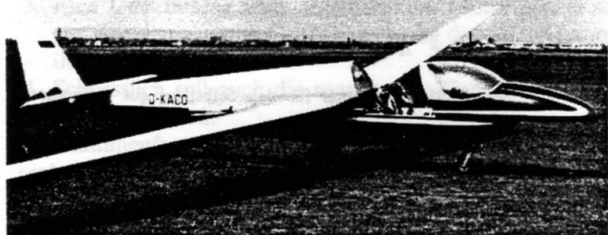
MS 60 von A. Pützer (1961), ein Triebwerk auf 2 Faltschrauben, Schiebehäube, Einziehfahrwerk
