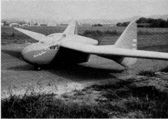
Fig. 3. AV 45 n° 02 prenant le départ montrant le même affinement avec verrière descendant plus bas et panneaux vitrés en dessous, ce qui donne une visibilité très étendue également vers le bas
